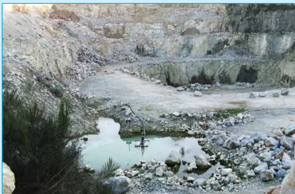
Figure 128 Bassin de fond de fosse isolé
