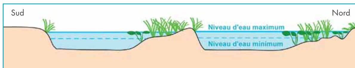
Figure 137 Schéma d'aménagement écologique d'une série de bassins sur une carrière de Charente
