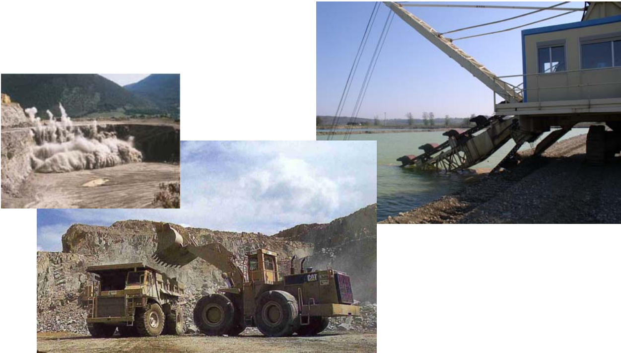
Figure n°7 : Photos d'extractions du granulat en alluvionnaire et en roche massive (source : GERARD 2004 et UNICEM 1997)
