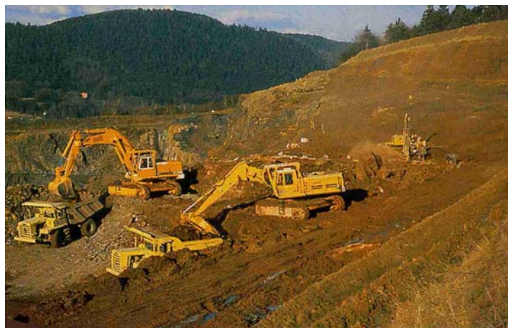
Figure n°6 : Photo du décapage d'un site d'exploitation (source UNICEM 1997)
