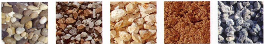
Figure n°5 : Photos des différents types de granulats (de gauche à droite : alluvionnaire, éruptif, calcaire, sable marins et laitiers d'aciéries) (source UNICEM 1997)
