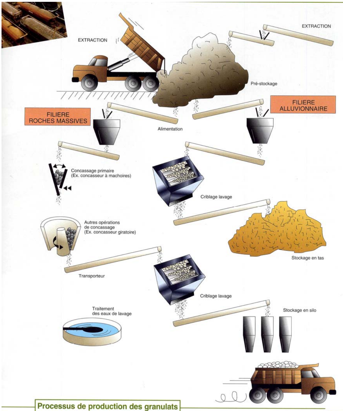
Figure n°8 : Schéma du processus de production du granulat (source UNICEM, 1997)
