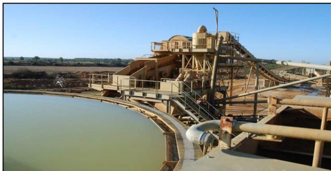
rapidement. Le recyclage de l'eau de lavage est par voie de conséquence optimisé; le volume de boues à décanter est réduit; l'espace nécessaire aux bassins de décantation est maîtrisé et les possibilités de réaménagement du site améliorées.
