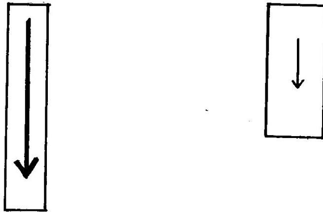
Fig. 43 : Un bassin étroit entraîne une augmentation de la vitesse d'écoulement.
