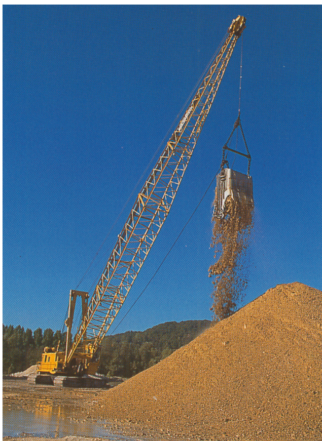
Fig. 12 : Extraction en site immergé à l'aide d'une dragueline.
