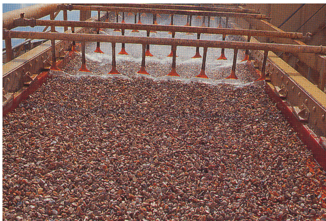
Fig. 18 : Lavage de granulats par jet d'eau.
