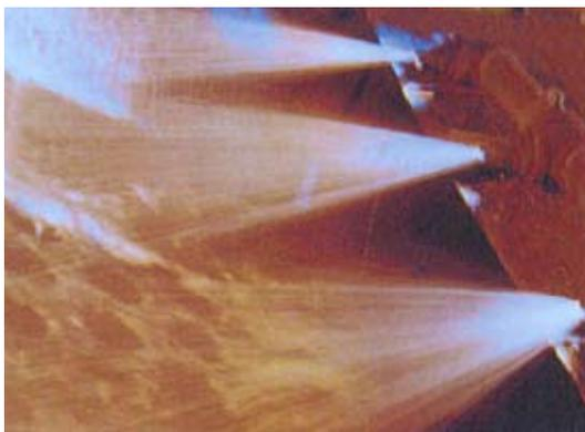
**Mousse appliquée au niveau d'un changement de bande transporteuse**
