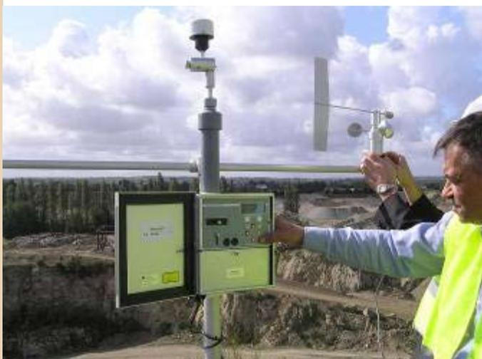
Néphélomètre en cours d'installation
