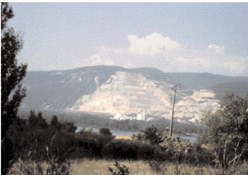
Disposition à flanc de colline associée à une réflexion sur une surface liquide. Compte tenu des réflexions sur les fronts de taille, toute source sonore voit son niveau sonore sensiblement doublé. Une telle structure est très difficile à protéger du bruit
